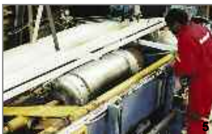
Συγκρότημα δοκιμής πίεσης των δεξαμενών.
