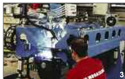
Ρομπότ οριζόντιας συγκόλλησης των δεξαμενών.
